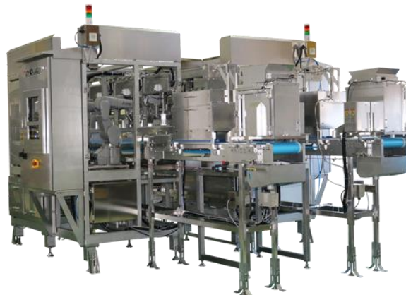
トリダス自動投入ロボットシステム（多関節ロボットアーム 3 台仕様）
